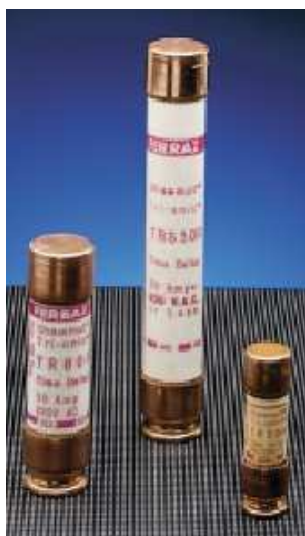
Figure 6 : fusible américain Time Delay avec "dual élément" pour la protection de circuit moteur
